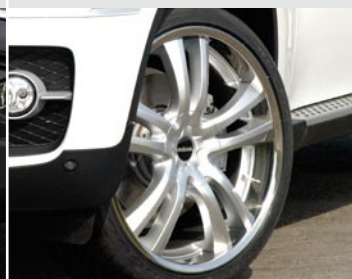
Felge/Wheel Lander. Mono- block-Felge mit Edelstahltief- bett. In 20x9 und 22x9.
