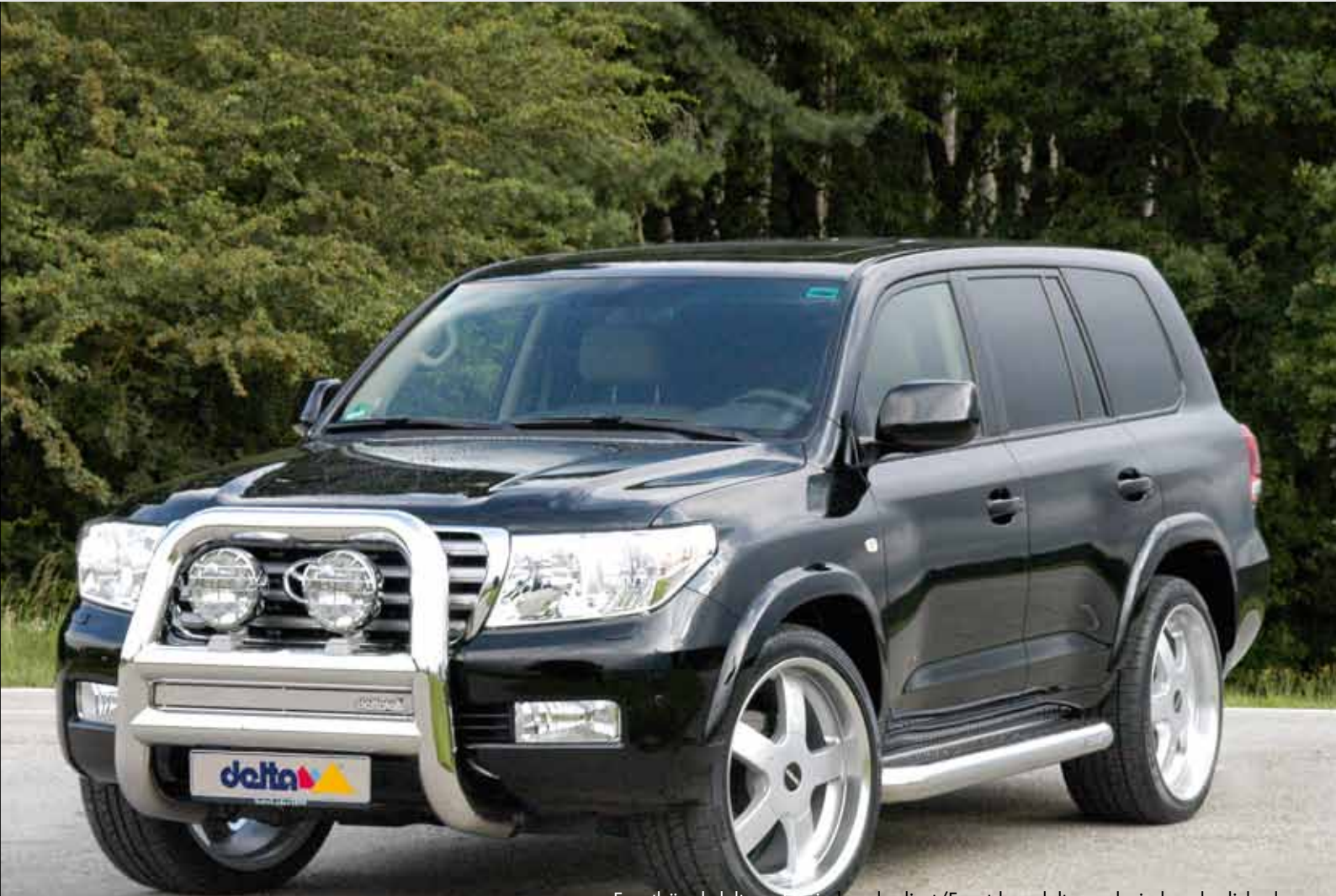
Frontbügel delta exklusiv handpoliert/Front bar delta exklusiv handpolished, Edelstahl Seitenbügel delta exklusiv handpoliert/Side bar stainless steel handpolished Felgen/Wheels E4 23x11, Reifen/Tires 305/35-23 Kofflügelformverbreiterung/Fender flares PIAA Scheinwerfer 550/PIAA Lights 550
