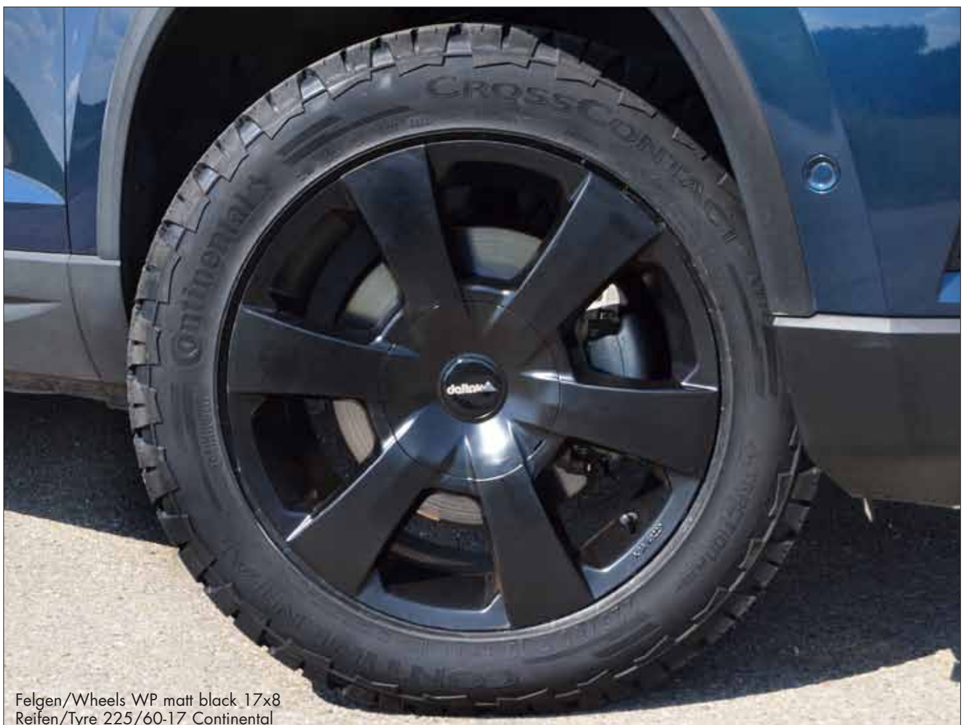
Felgen/Wheels WP matt black 17x8 Reifen/Tyre 225/60-17 Continental Höherlegung/Body Lift Kit 20 mm
